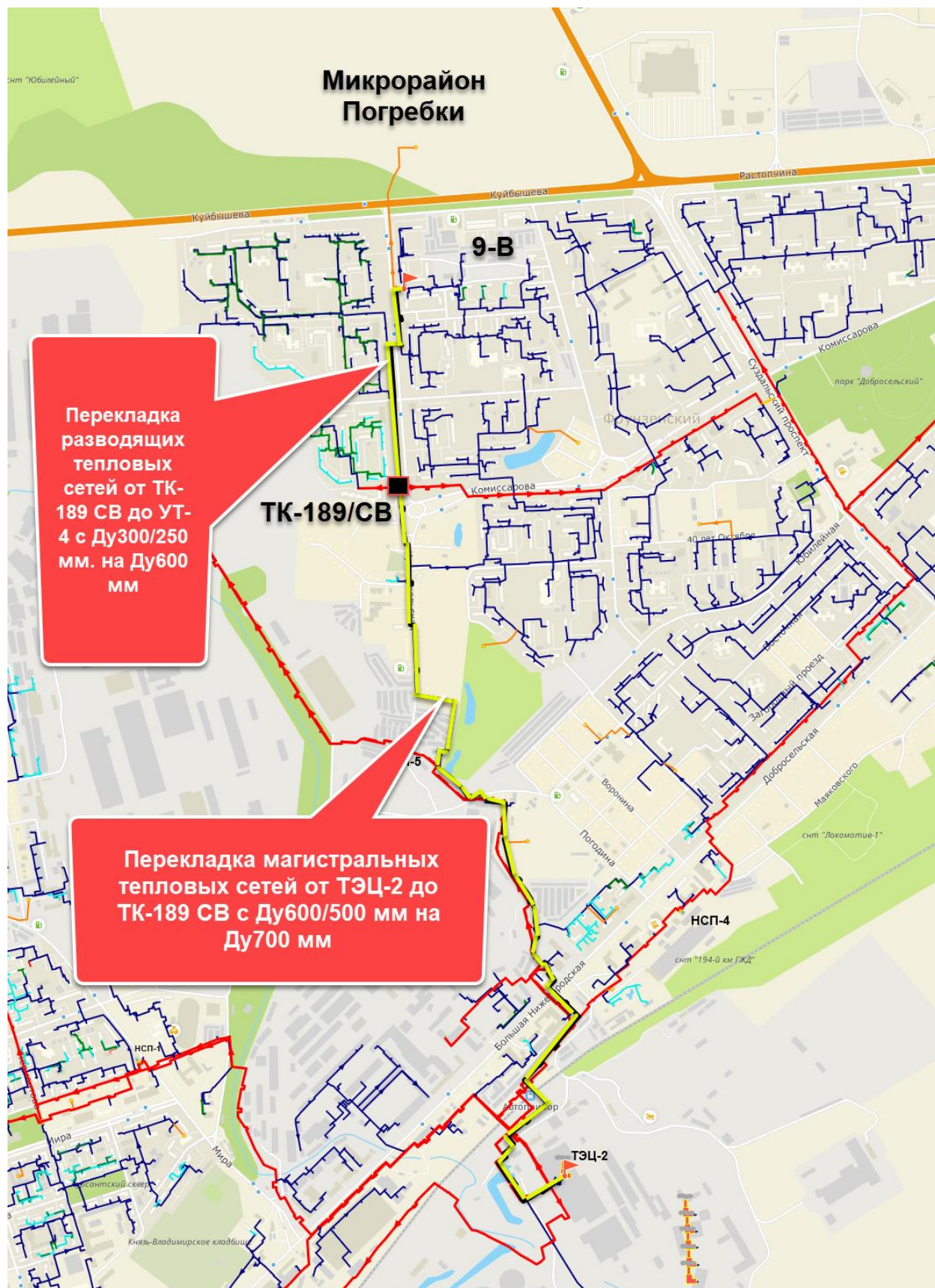
Рисунок 2 – Планы по увеличению диаметров трубопроводов от Владимирской ТЭЦ-2, для переключения тепловой нагрузки от котельной 9-В и подключения перспективной нагрузки района «Погребки»
