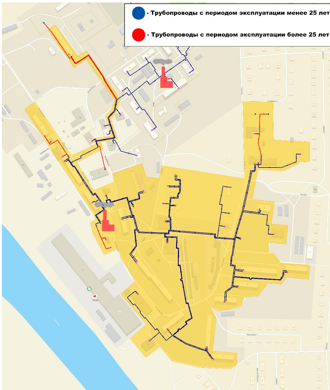
Рисунок 144 –Период эксплуатации трубопроводов котельной Оргтруд 1 (ЕТО-1)
