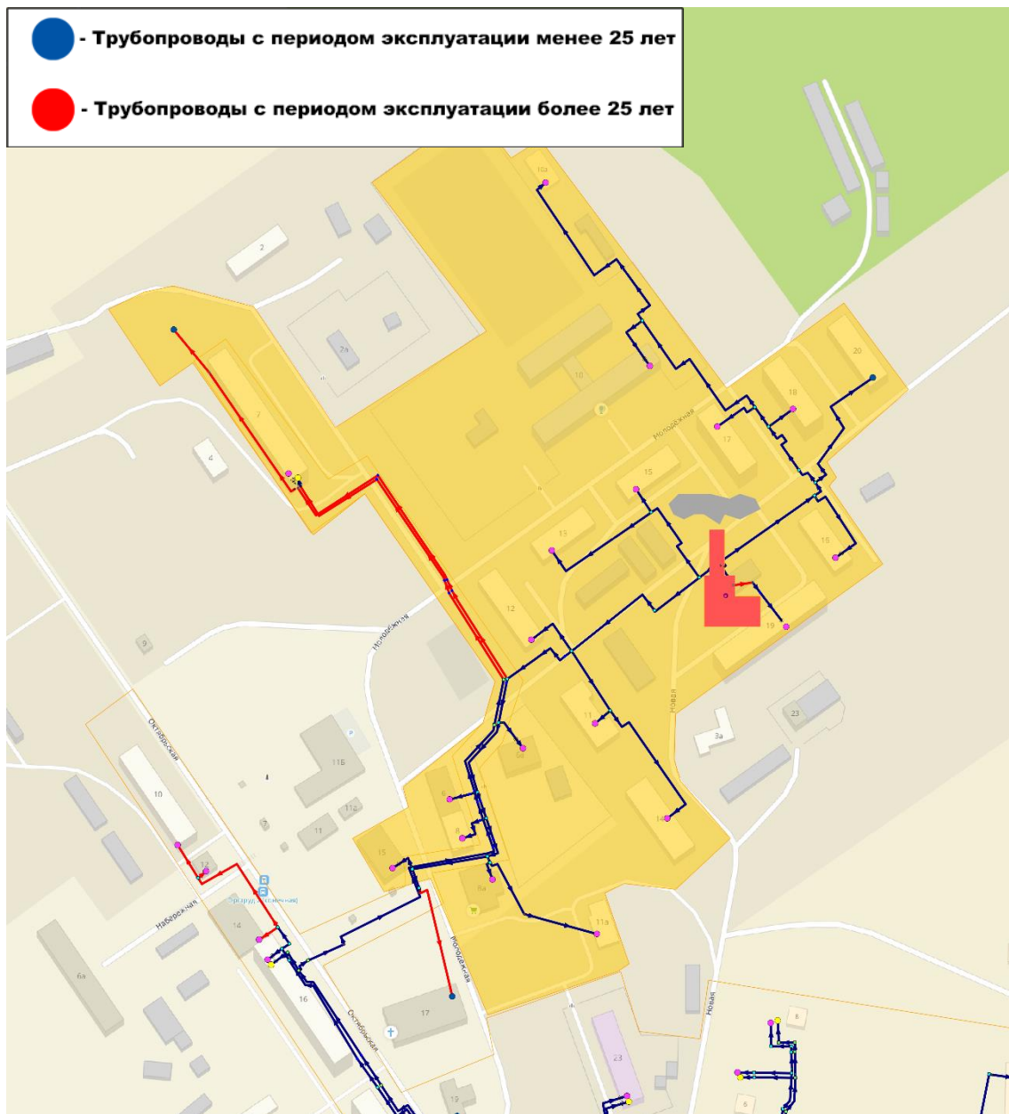
Рисунок 145 –Период эксплуатации трубопроводов котельной Оргтруд 2 (ЕТО-1)
