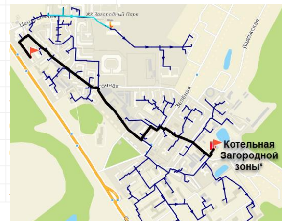
Рисунок 61 – Пьезометрический путь от котельной «Загородной зоны» до самого отдалённого потребителя (расстояние от котельной составляет 1,5 км). Располагаемый напор 4 м вод. ст.- Ниже допустимого.
