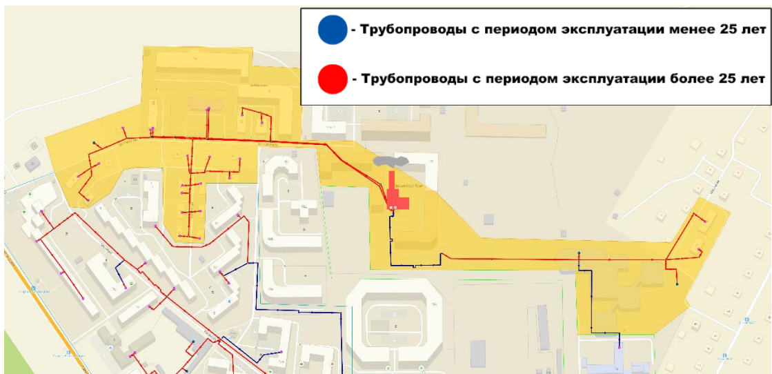
Рисунок 142 –Период эксплуатации трубопроводов котельной мкр. Коммунар (ЕТО-1)
