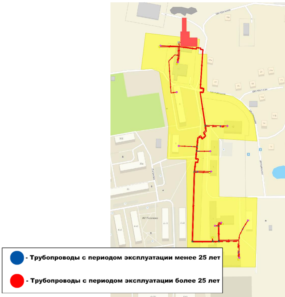
Рисунок 146 –Период эксплуатации трубопроводов котельной п. Пиганово, ООО «Владимиртеплогаз» (ЕТО-1)
