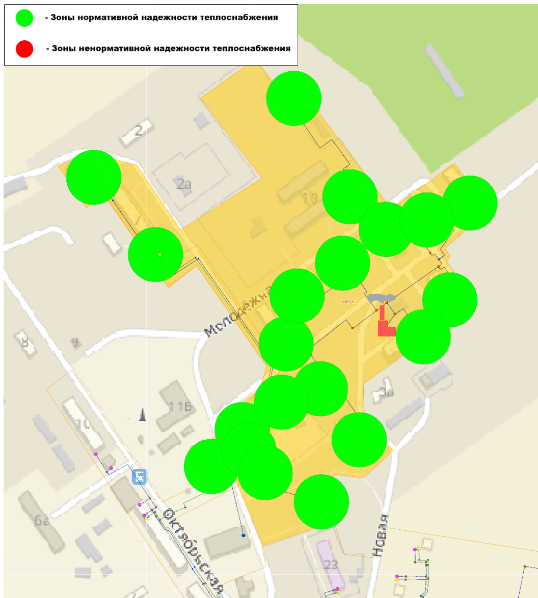
Рисунок 122 – Зоны ненормативной надежности теплоснабжения котельной Оргтруд 2 (ЕТО-1)
