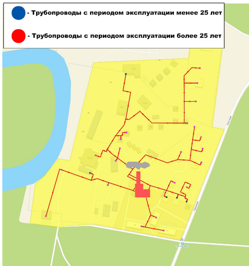
Рисунок 149 –Период эксплуатации трубопроводов котельной турбаза «Ладoga», ООО «Владимиртеплогаз» (ЕТО-1)
