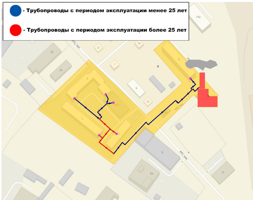
Рисунок 148 –Период эксплуатации трубопроводов котельной РТС (ЕТО-1)
