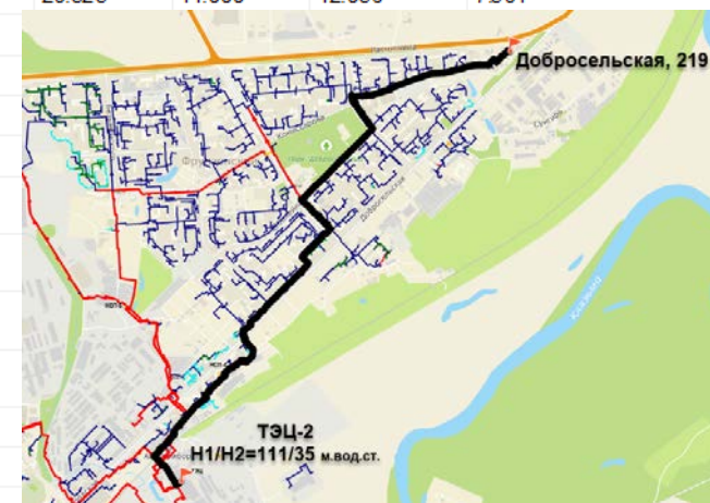
Рисунок 5 – Пьезометрический путь от Владимирской ТЭЦ-2 до самого отдалённого потребителя в северо-восточной части города (расстояние от Владимирской ТЭЦ-2 составляет 5,6 км). Располагаемый напор 8 м. вод. Ст.
