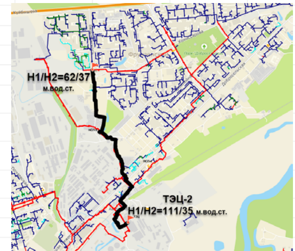
Рисунок 11 – Пьезометрический путь от ТЭЦ-2 до контрольной камеры ТК-189 СВ (3,2 км). Располагаемый напор 31 м вод. ст. Отклонение параметров по давлениям в модели от факта около 5%.
